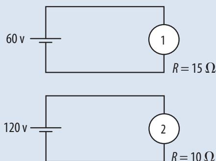
41. El operario tiene a su disposición diferentes fuentes y quiere conectar los dos aparatos en serie pero debe quedar funcionando el aparato 1 con la máxima corriente. La fuente que debe usar es:
